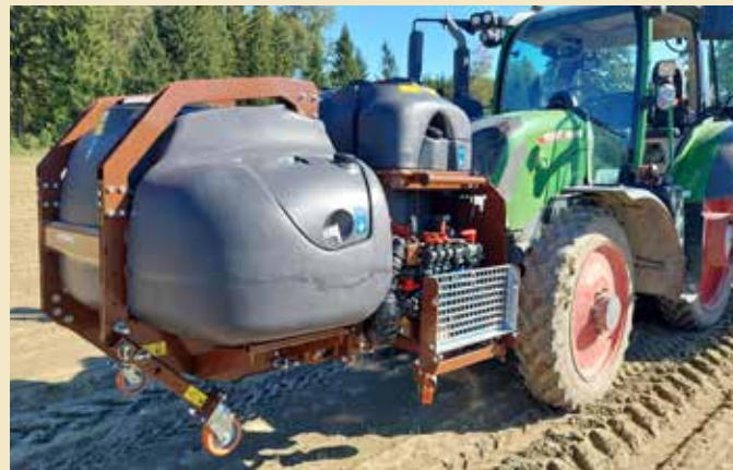
Abb. 3: 400 l Fronttank und 800 l Frischwassertank. BWSB/WALLNER
