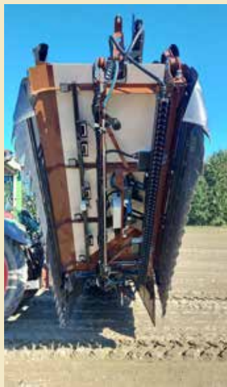
Abb. 2: Spot-Sprayer – Ansicht Kamerasystem und Spritzbalken: das punktgenaue System ermöglicht Einsparungen bei der Aufwandmenge. BWSB/WALLNER
