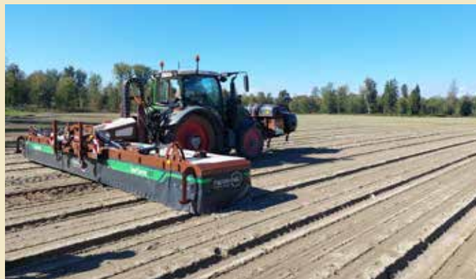
Abb. 1: Spot-Sprayer im Einsatz in einem jungen Zwiebfelbestand. Die seitlichen Schutz- planen erlauben auch bei windigem Wetter eine Pflanzenschutzmittelanwendung.
