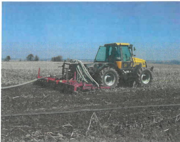
Abb. 6: Mittels Güllegrubber oder Gülleinjektor erfolgt die Ausbringung und Einarbeitung in einem Arbeitsgang.
