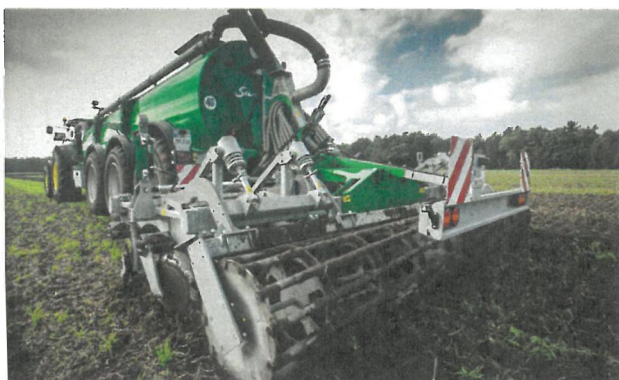
tels Güllegrubber oder Gülleinjektor erfolgt die Ausbringung und Einarbeitung in einem Arbeitsgang.
