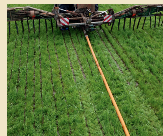
Abb. 1: Bei der Gülleausbringung mittels Schleppschauch werden die Ammoniakemissionen um ca. 30 % reduziert.
