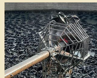
Abb. 1: Schutzkorb beim Güllemixer.
