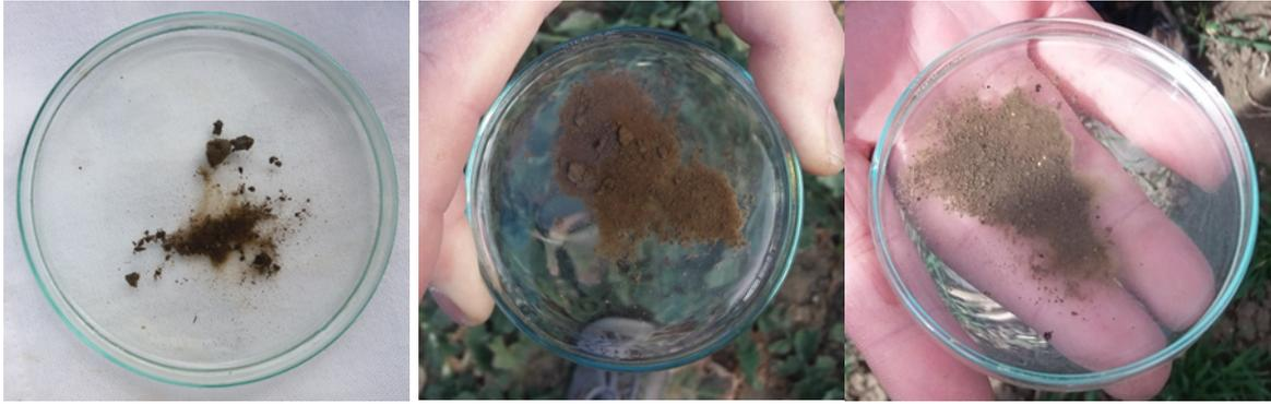
Bild links: Echte Krümel sind wasserbeständig. Der Boden verschlämmt nicht.
