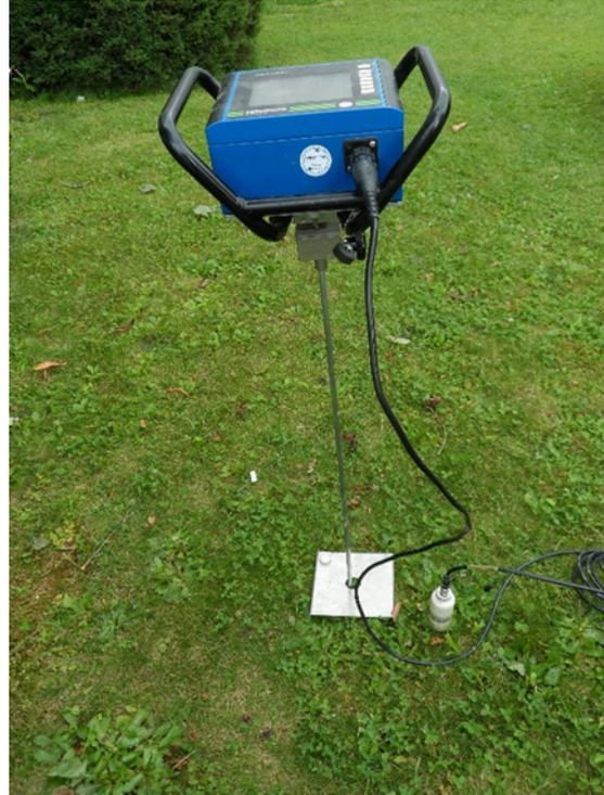
Mit der Bodensonde erhält man über subjektiv spürbare Widerstände im Boden Informationen über relative Dichteunterschiede. Unter frischen Bodenbedingungen (Boden im bearbeitbaren Zustand, krümelt in der Hand) drückt man die Sonde langsam und behutsam senkrecht in den Boden, um Unterschiede im Widerstand wahrzunehmen. Durch die Markierungen am Gerät kann man die jeweilige Eindringtiefe ablesen.
