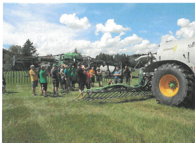
Die streifenförmige bodennahe Ausbringung stellt aufgrund der klaren Nachweisbarkeit und des hohen Emissionsreduktionspotenzials die zentrale Maßnahme zur Erreichung des Ammoniak-Emissionsminderungsziels dar. Verdünnte oder separierte Rindergülle ist die Voraussetzung für eine möglichst störungsfreie Umsetzung.
