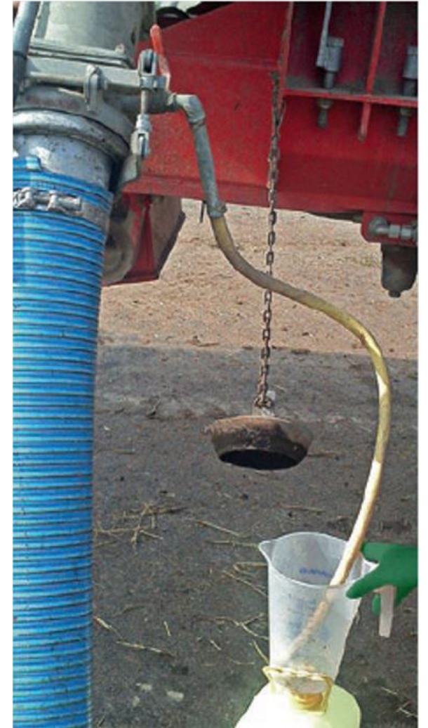
Zudosierung über Bypass
