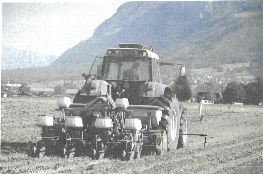
Bei der Streifenfrässaat wird der Boden mit einer Fräse streifenweise „aktiv“ bearbeitet.
