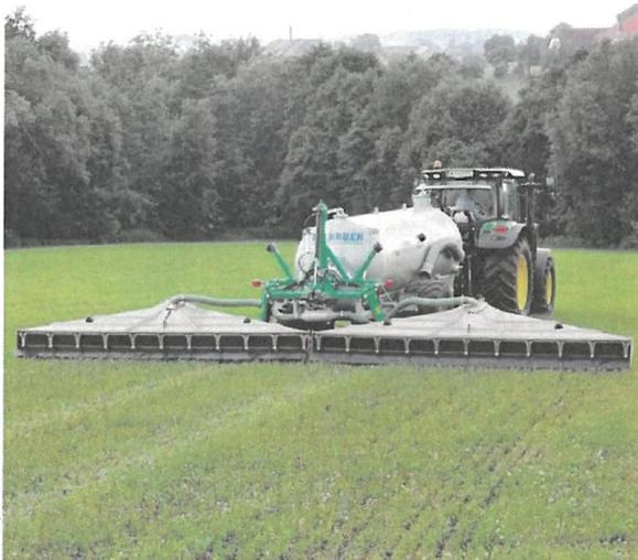
Bodennahe Gülleausbringung mit dem System „Schleppfix“, das im ÖPUL als „Schleppschuhverfahren“ anerkannt wird.
