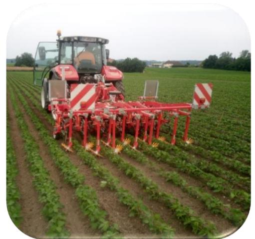
Hacken 2022: Hackgerät, Chopstar mit Kameralenkung und Fingerräder
