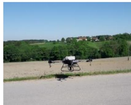
Erosionsschutzstreifeneinsaat bei Mais mittels Drohne (18. Mai 2022) in Lambrecht.
