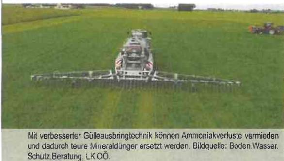
Mit verbesserter Gülleausbringtechnik können Ammoniakverluste vermieden und dadurch teure Mineraldünger ersetzt werden. Bildquelle: Boden.Wasser.Schutz.Beratung, LK OÖ.
