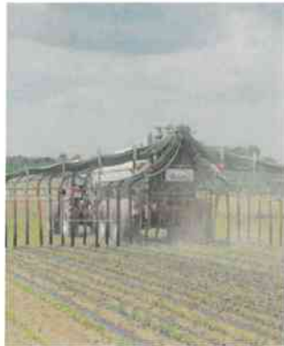
Die bodennahe Ausbringung erlaubt es, Gülle möglichst verlust- und verschmutzungsarm auszubringen. BWSB
