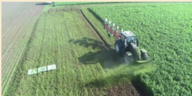
Abb 7: Das Pflug-Mulch-System im Testeinsatz beim Auftrag von Mulchmaterial auf die letzte Furche der Versuchspartelle.
