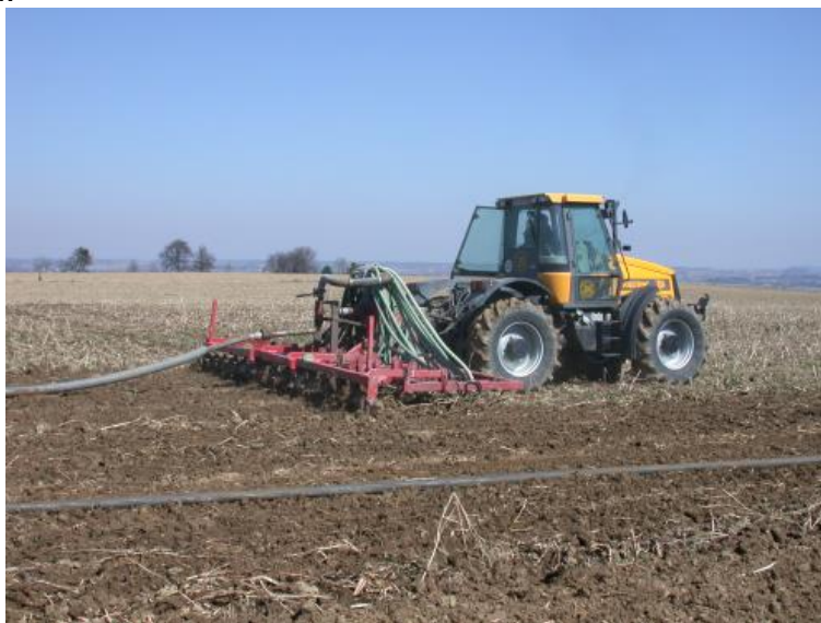
Bild 6: Die Gülleinjektion hat gemäß neuer Luftschadstoffinventur den höchsten Reduktionsfaktor von 80 %. Diese Technik wird primär auf Ackerland empfohlen. (Quelle: Hölzl)
