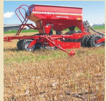
Wellscheiben zum Aufschneiden des Säschlitzes und Produktion von lockerer Erde zum Schließen des Schlitzes. Das Saatgut soll auf dem unberührten Horizont wegen der Kapillarität liegen und von lockerer (nicht verdichteter) Erde bedeckt sein.
