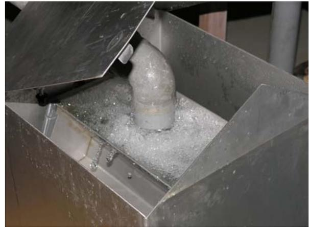
Abb. 4: Hoher Volumenstrom (ca. 90 l min<sup>-1</sup>).
