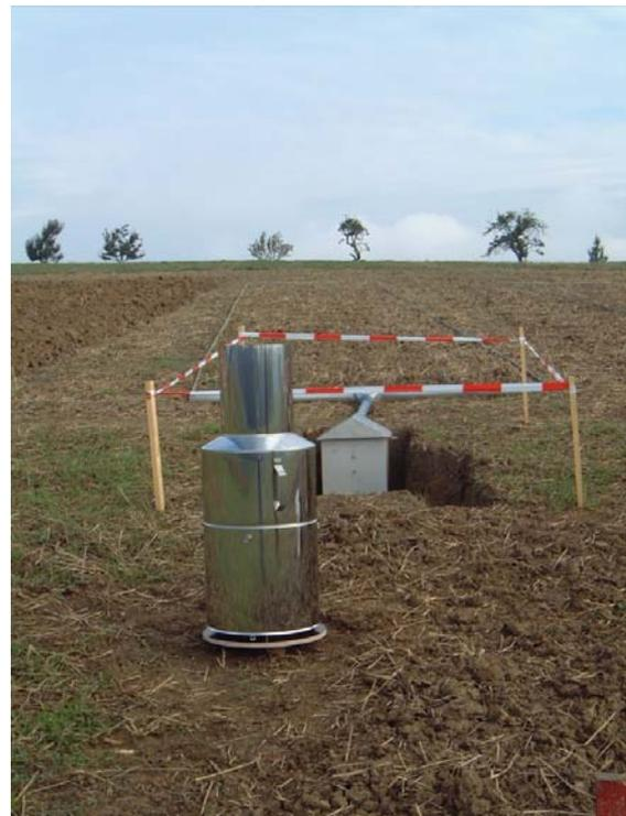
Abb. 17: Niederschlagswaage
