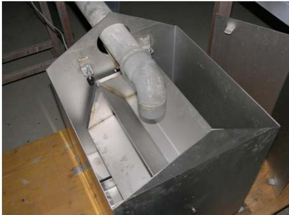
Abb. 3: Mess- und Teilkasten (Prototyp).
