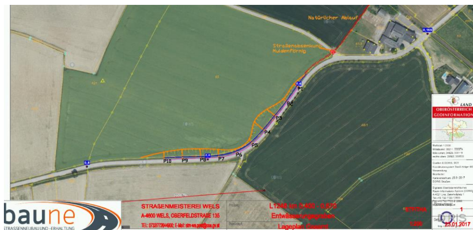
Bild 8: Geländeaufnahme Entwässerungsgraben, Straßenmeisterei Wels
