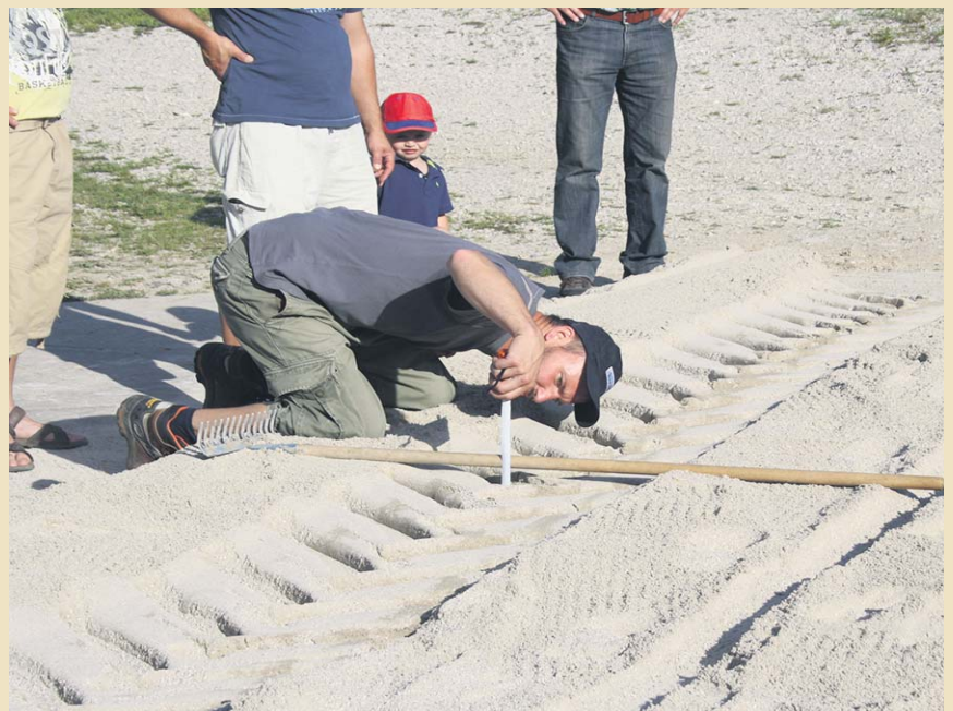
Veranschaulichung der Bedeutung des richtigen Reifendrucks – Messung der Eindringtiefe auf feinem Sand. FOTOS: BWSB
