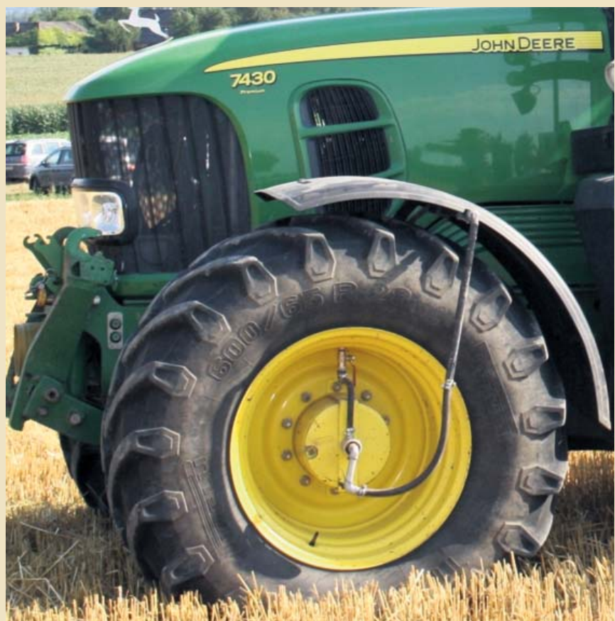
Reifendruckregelanlage zur Regulierung des Reifendruckes – Förderung ist möglich
