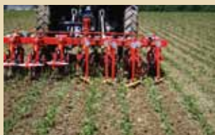
Chopstar Hackgerät von Einböck mit Striegel und Fingerhackelementen.
