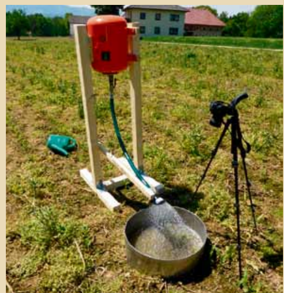
Messung der Infiltrationszeit auf einer Parzelle.
