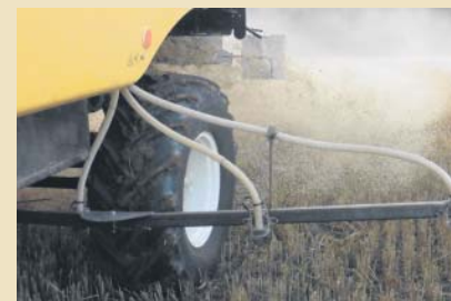
Pneumatisches Säugerät mit klappbarem Gestänge und Pralltellern im Zwischenachsbereich. BWSB
