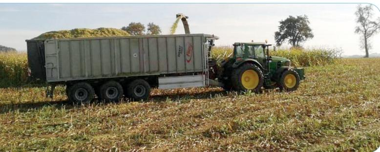
*Besonders bei der Ernte können durch hohe Radlasten in Kombination mit feuchten Bodenbedingungen Schadverdichtungen entstehen.*
