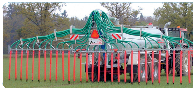
Eine bodennahe Gärrestausrückung minimiert die Gefahr von Stickstoffverlusten.
