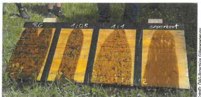
Abb. 4: Nur bei der Gülleseparierung werden die Feststoffe entfernt und damit das Risiko der Futterverschmutzung minimiert.
