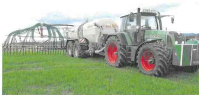
Die bodennahe Ausbringung mittels Schleppschuhtechnik erlaubt es, in Grünland- und Ackerfutterbestände Gülle möglichst verlust- und verschmutzungsarm auszubringen.
