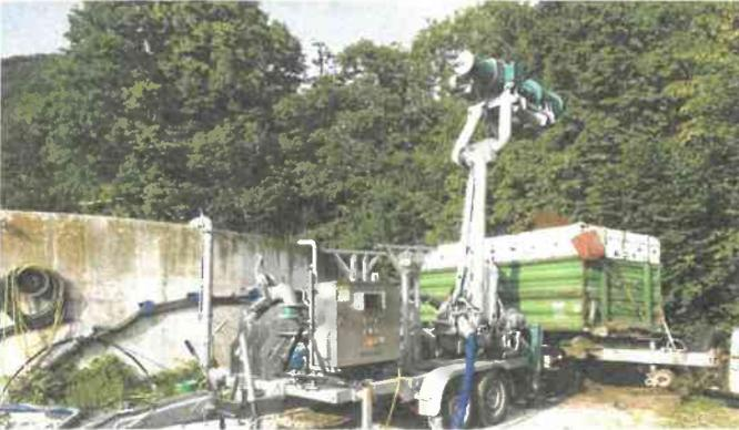
Abbildung 8: Durch Separierung wird die Einsetzbarkeit und Fließfähigkeit der Gülle deutlich verbessert. Die flüssige Dünngülle dringt rascher in den Boden ein, wodurch der Stickstoff rascher wirksam wird. Eine Gülleausbringung im Grünland ist nach allen Schnitten möglich. Der Feststoff ist ideal zum Humusaufbau geeignet. Bildquelle: Ing. Armin Steiner, Lohnunternehmen Steiner.
