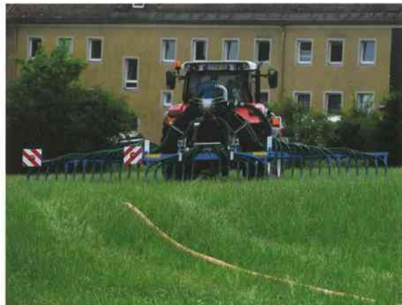
Mit bodenschonenden Ausbringgeräten wie beispielsweise Selbstfahrer mit Niederdruck-Breitbereifung oder mittels Verschlauchung wird die Gülle nah an der Wurzel ausgebracht. Güllegrubber oder Schlitzgeräte sorgen für eine nahezu emissionsfreie Ausbringung. Bildquelle links: Holmer.
