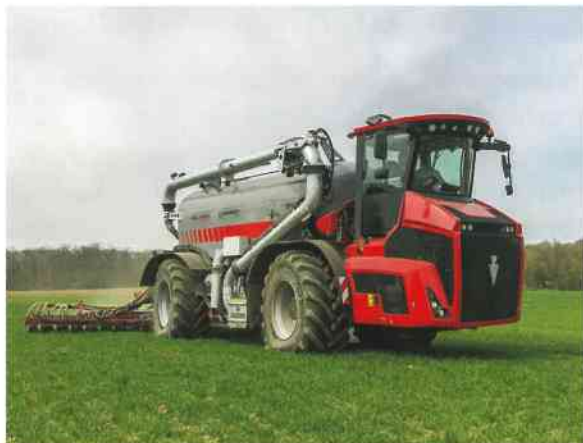
Mit bodenschonenden Ausbringgeräten wie beispielsweise Selbstfahrer mit Niederdruck-Breitbereifung oder mittels Verschlauchung wird die Gülle nah an der Wurzel ausgebracht. Güllegrubber oder Schlitzgeräte sorgen für eine nahezu emissionsfreie Ausbringung. Bildquelle links: Holmer.
