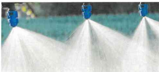
Mit abdriftmindernder Düsenteknik lässt sich der Abstand zu Gewässern merklich reduzieren.
