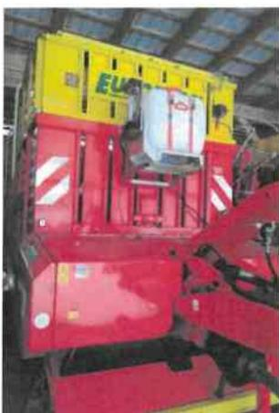
Die gleichmäßige Verteilung mittels Dosiereinrichtung zeigt die beste Wirkung. BRH/Unterbrunner
