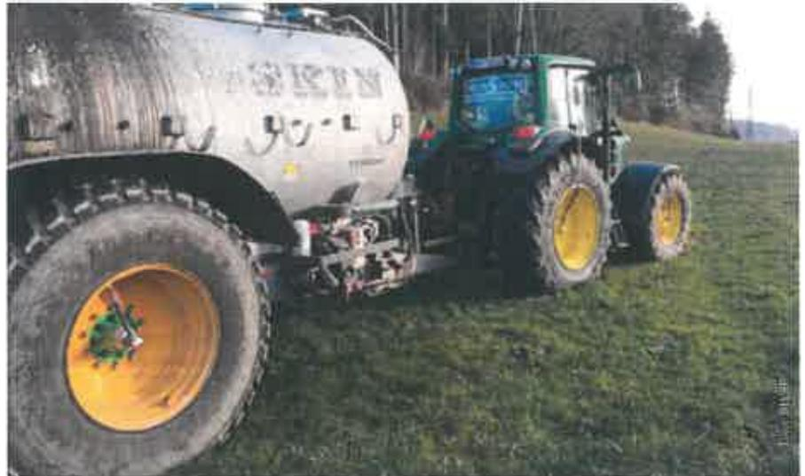
Abb. 6: Reifendruckregelanlage der Firma Terra Smart am Güllefass.
