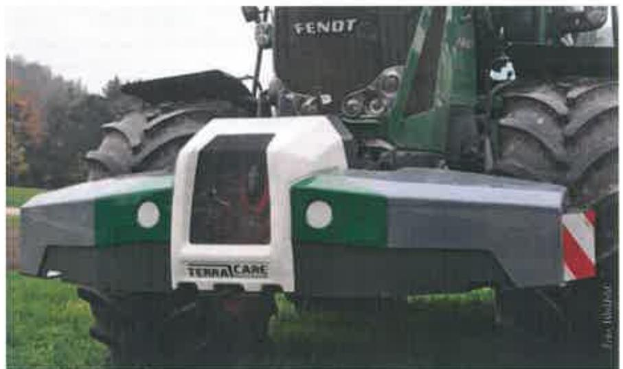
Abb. 7: Airpower der Firma Terra Care: Kompressor und Frontgewicht in einem.
