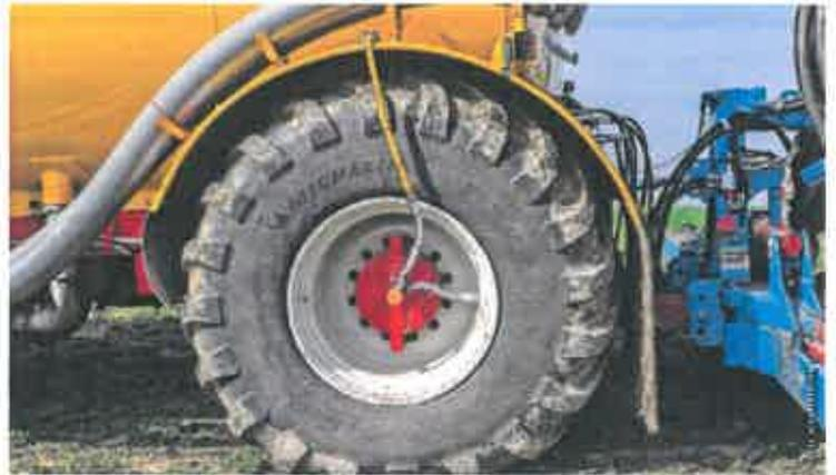
Reifendruckregelungssysteme gibt es in unterschiedlichen Ausführungen, so auch für Gülle selbstfahrer. Gerade bei derart schwerbeladenen Landmaschinen ist eine Druckanpassung zur Bodenschonung essentiell.
