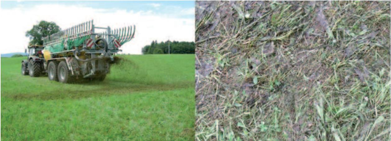
Abb. 3: Gülleausbringung mittels Prallteller (PT) und das Spritzbild nach Ausbringung
