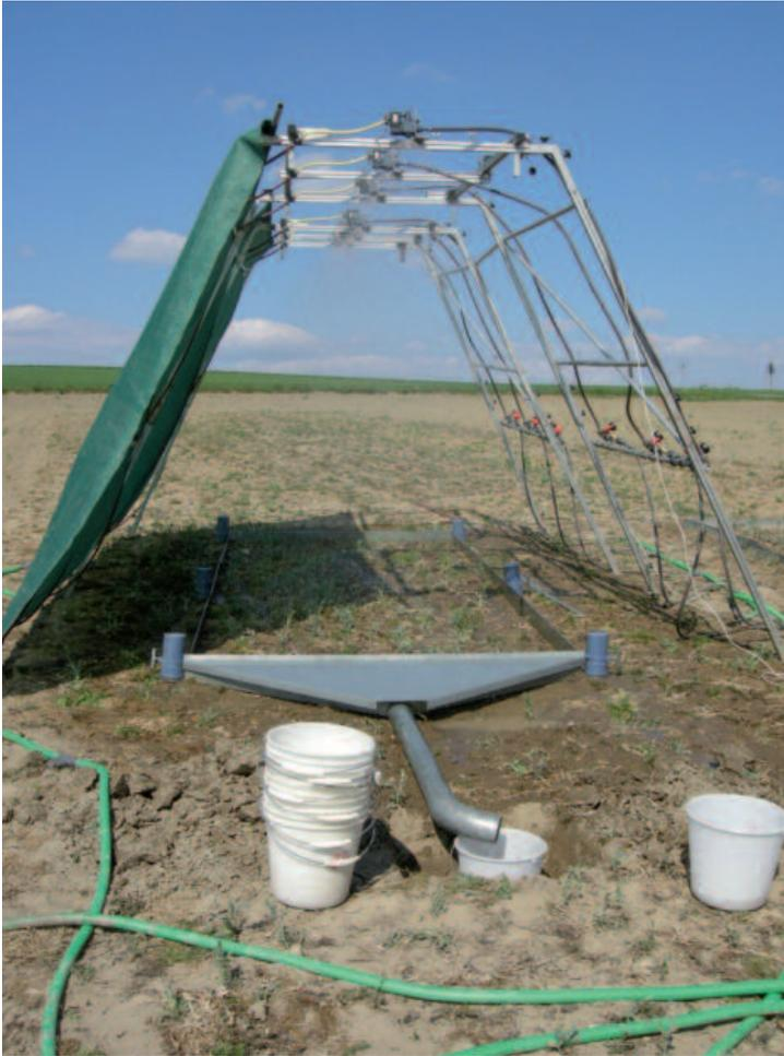
Abb. 1: Versuchsaufbau für Beregnungsversuche, im Bild die Variante NT1 aus dem Jahr 2011
