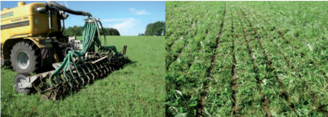
Abb. 6: Gülleausbringung mittels Gölledrill (D) und das Spritzbild nach Ausbringung
