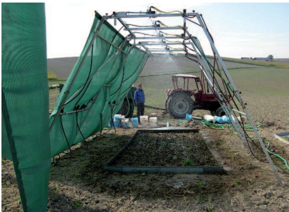
Abb. 13: Beregnungsversuch im Teileinzugsgebiet Antiesen; Foto: BAW
