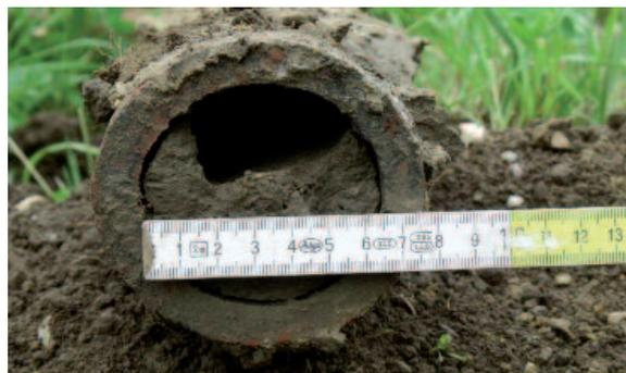
Abb. 2: Mit Sediment gefülltes Drainagerohr
