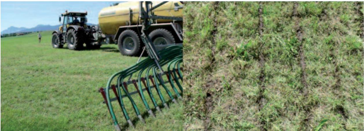
Abb. 4: Gülleausbringung mittels Schleppschuh (SH) und das Spritzbild nach Ausbringung
