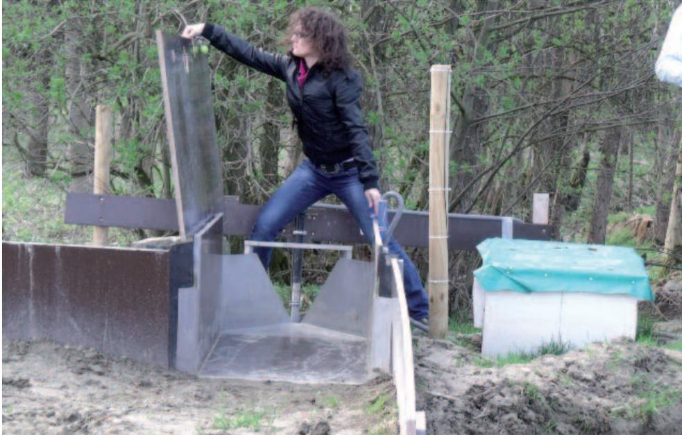
Abb. 16: Messstelle zur Erosionsermittlung, Teileinzugsgebiet Antiesen/Asböckbach 2011; Foto: AELF
