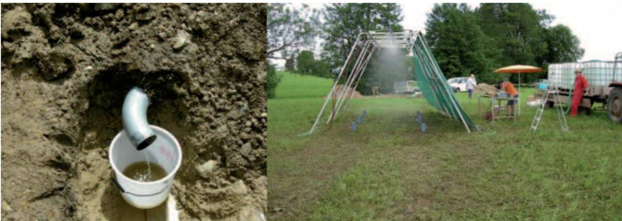
Abb. 7: Drainage mit Ableitstutzen für Probenahme und Beregnung
