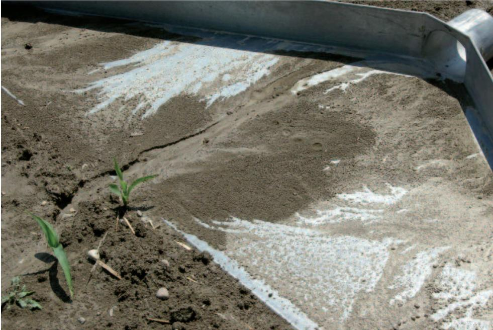
Abb. 24: Erosionsmessstelle im Teileinzugsgebiet Asböckbach (Modellgebiet Antiesen); Foto: BAW
