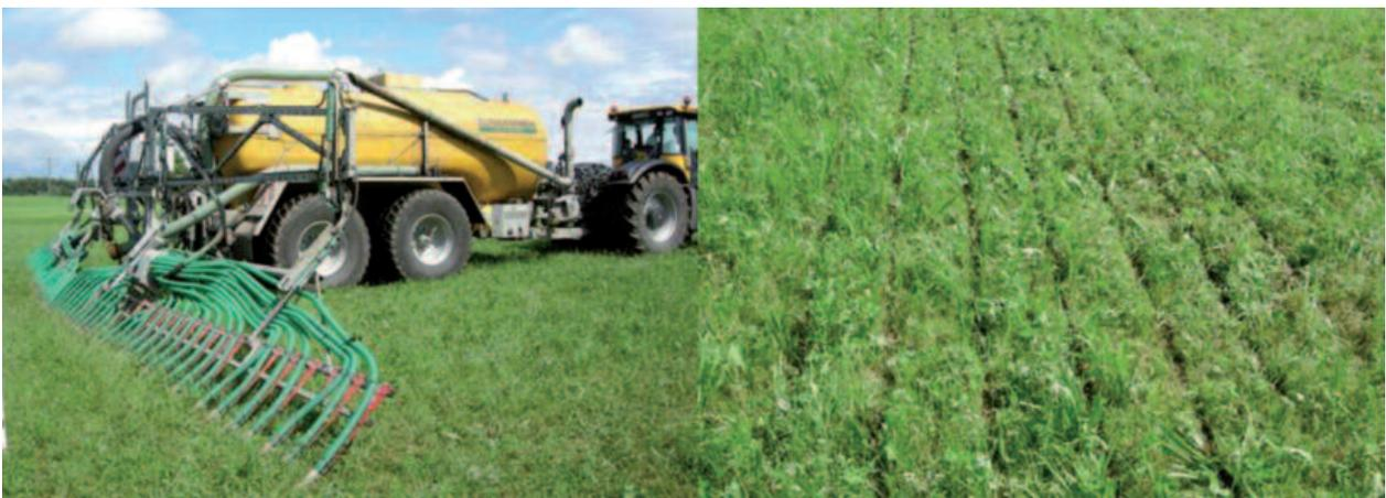
Abb. 5: Gülleausbringung mittels Schleppschlauch (SC) und das Spritzbild nach Ausbringung
