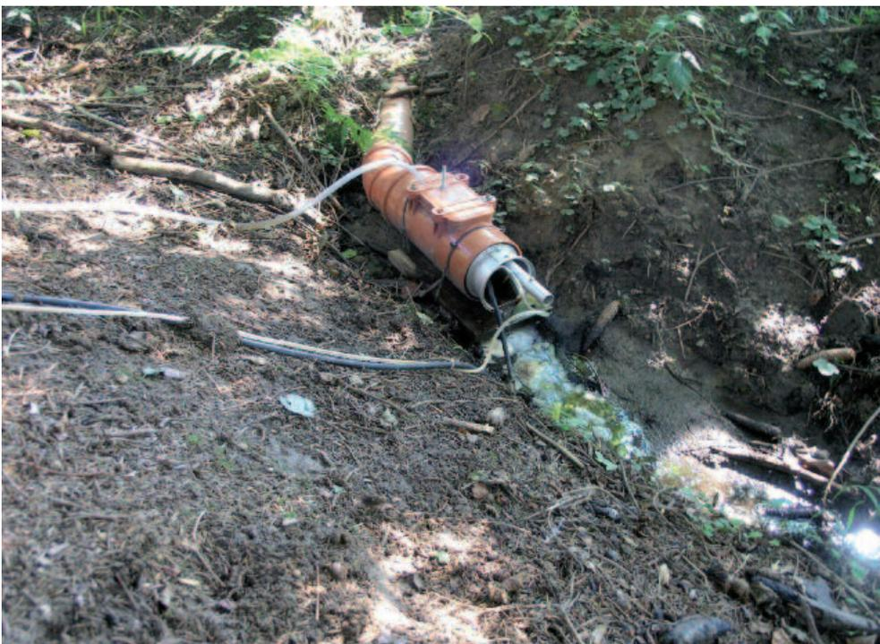
Abb. 15: Wasserprobenahme am Ausgang des Drainagesammlers, Wonneberg 2010; Foto: AELF
