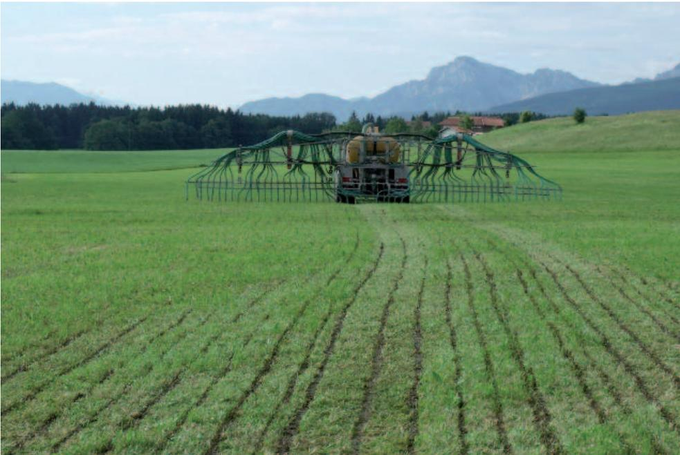
Abb. 28: Gülleausbringung mit dem Schleppschlauch; Foto: AELF
