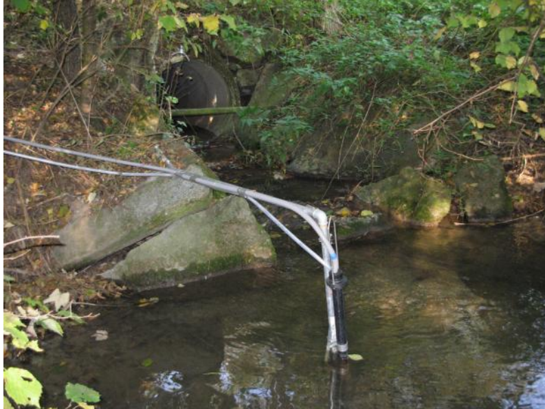
Abbildung 11 Feststoffsonde (schwarz) und Schlauch des Probensammlers (weiß) an der Messstelle Asböckbach 2
