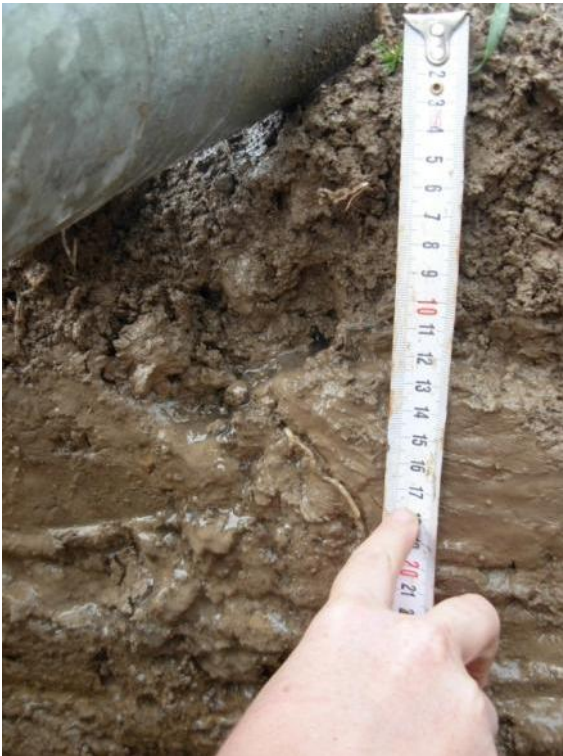
Abbildung 26 Interflow oberhalb eines verdichteten Bodenhorizontes
