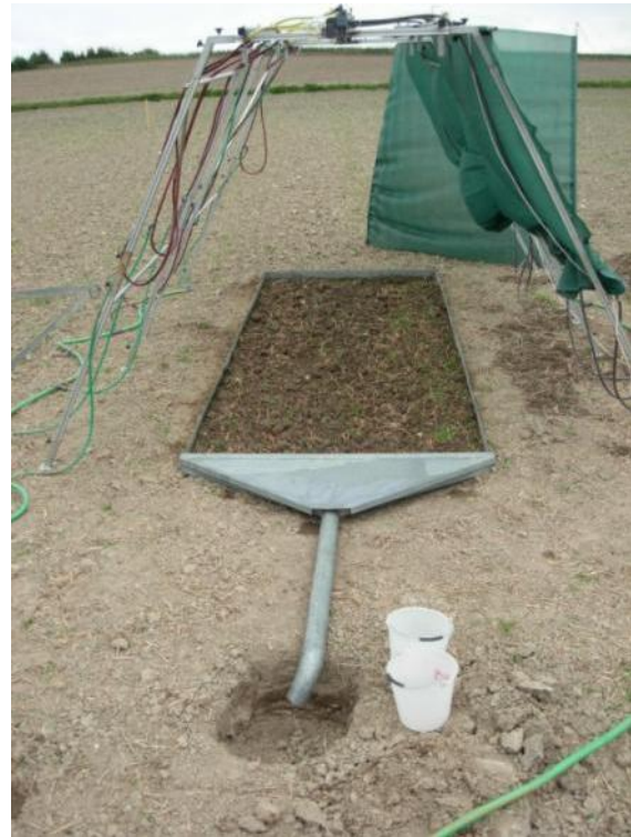
Abbildung 27 Aufbau eines Beregnungsplot
