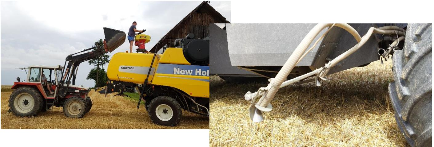
Links: Befüllen des Feinsamenstreuers; rechts: Saatgestänge bei Mährescher vor Hinterachse
