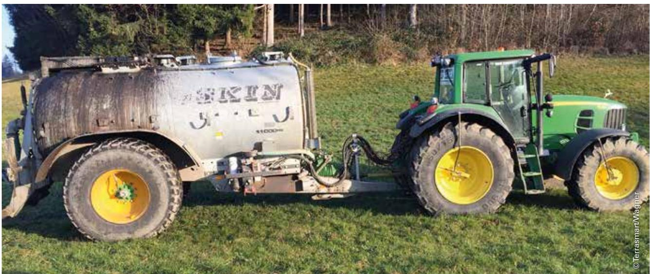
**Abbildung 17:** Durch Reifendruckregelanlagen kann die Belastung des Bodens ( $\text{kg} / \text{cm}^2$ ) reduziert werden.
