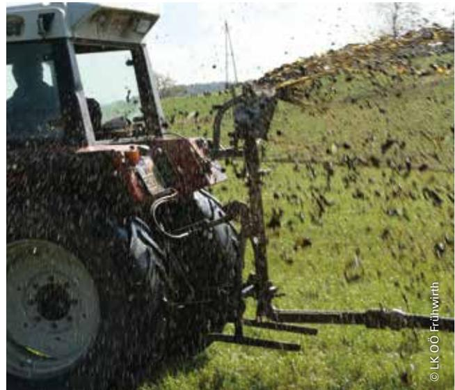
**Abbildung 10:** Großtropfige Gülleausbringtechnik verringert Verluste.
