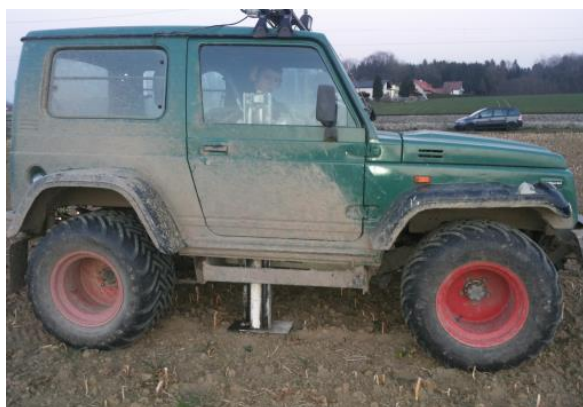
Bodenprobenziehung mit einem speziellen Bodenbohrer (BWSB)
